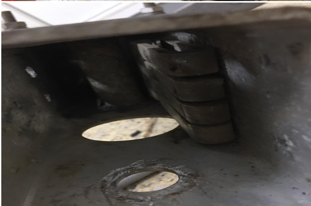
Hình ảnh tiếp điểm lưỡi dao DCL bị phát nhiệt, đơn vị QLVH tháo ra để xử lý tiếp xúc
