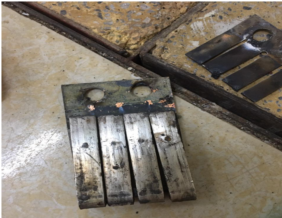
Các lá đồng cực tiếp điểm lưới DCL bị phóng điện, rỗ bề mặt tiếp xúc
